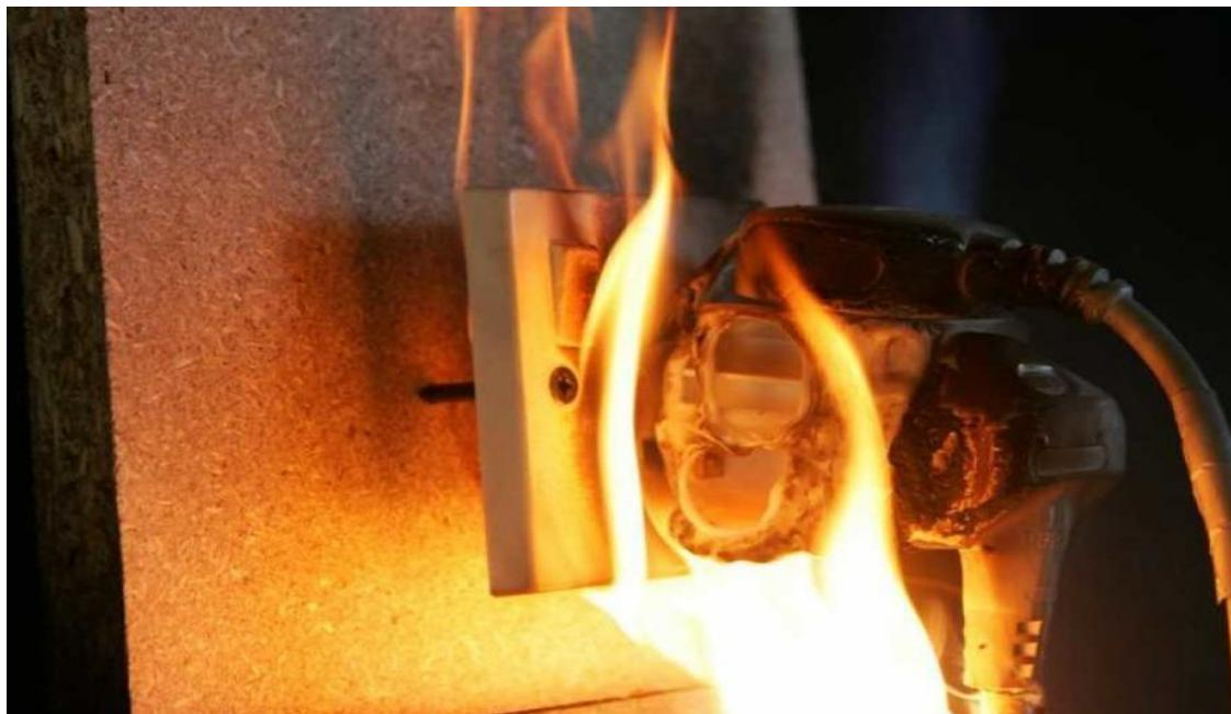
Одной из основных причин пожаров является нарушение правил эксплуатации и монтажа электросети и электрооборудования, чаще всего - короткое замыкание и перегрузки электросети. Токи короткого замыкания возникают в результате повреждения изоляции токоведущих частей, неправильного выбора исполнения электрооборудования по условиям окружающей среды. В результате происходят перегревание и воспламенение изоляции проводов, а также расплавление их металлической токоведущей части.
